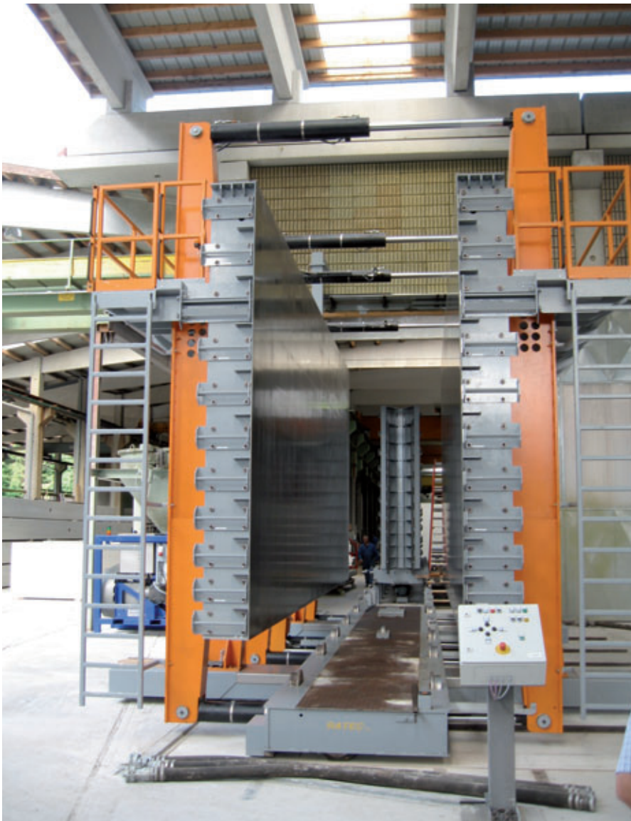
Abb. 8: Blick auf das Außentafelpaar der Upcrete-Batterieschalung
