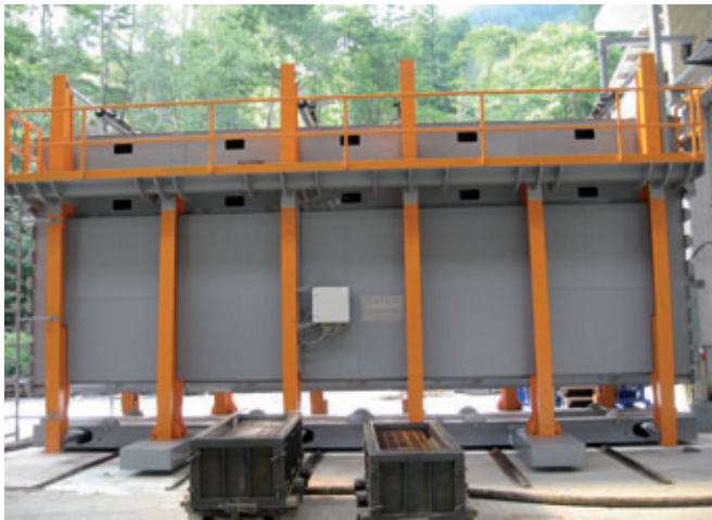
Abb. 6: Batterieschalung für die Upcrete-Technologie
